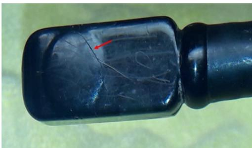
Con la amplificación y la iluminación mejorada utilizada en esta fotografía se pueden visualizar numerosos rasguños superficiales y una grieta (flecha) en la carcasa de plástico. El daño no era obvio a simple vista.
